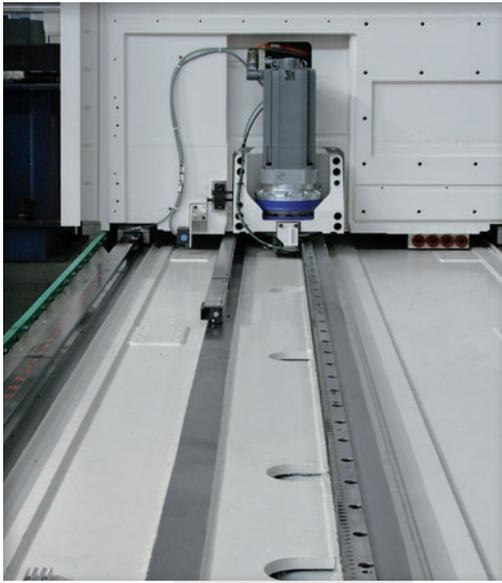
Struttura a montante mobile con corsa asse X (longitudinale) da 3 a 5 metri (Box version) e fino a 30 m (Open version). L'asse X è dotato di guide lineari a ricircolo rulli multipattino con sistema Dual Drive con doppio motore/pignone motorizzato e cremagliera di precisione.
