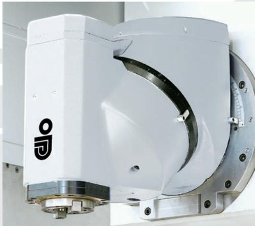
Frazer può essere equipaggiata con teste universali meccaniche continue o indexate (risoluzione minima con indexaggio di 0,02°). La testa Universale indexata tramite doppia corona HIRTH di precisione assicura massima precisione di posizionamento e grande capacità di asportazione.
