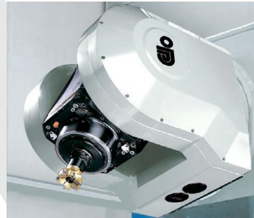
Frazer può essere in alternativa equipaggiata con teste ad elettromandrino con varie soluzioni di potenza e velocità per l'esecuzione di lavorazioni di leghe leggere e di finitura stampi ad alta velocità.
