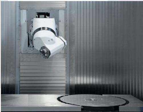
Possibilità di installare una tavola rotativa con portata fino a 3 tonnellate e/o una tavola di tornitura azionata da motori torque.
