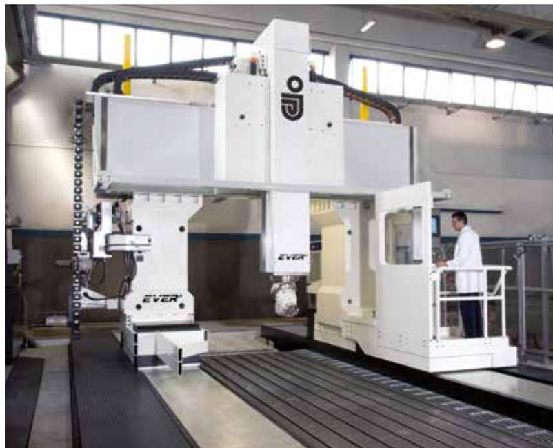
MT frame: struttura della traversa a sezione multi-triangolare, ottimizzata per la massima rigidità torsionale e flessionale e per l'alta efficienza dinamica
