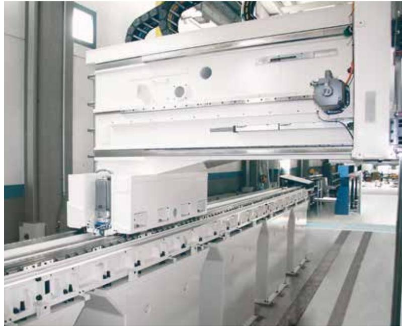
MT frame: struttura asse longitudinale (asse X) a sezione multi-triangolare, ottimizzata per la massima rigidità torsionale e flessionale e per l'alta efficienza dinamica
