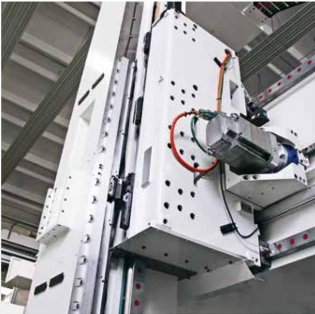
Struttura asse trasversale (asse Y) composta da una traversa in carpenteria elettrosaldata con due guide a rulli precaricati per lo scorrimento del carro asse Y
