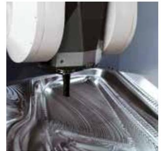
Il sistema BUSS (Basic Universal Spindle System) può accettare una vasta famiglia di teste universali, di teste meccaniche a 3, 3+2 e 5 assi e teste a 5 assi con elettromandrino per lavorazioni ad alta velocità di semifinitura e finitura.
